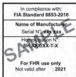
Рис. 1. Пример маркировки ремня в соответствии со стандартом FIA 8853-2016:
