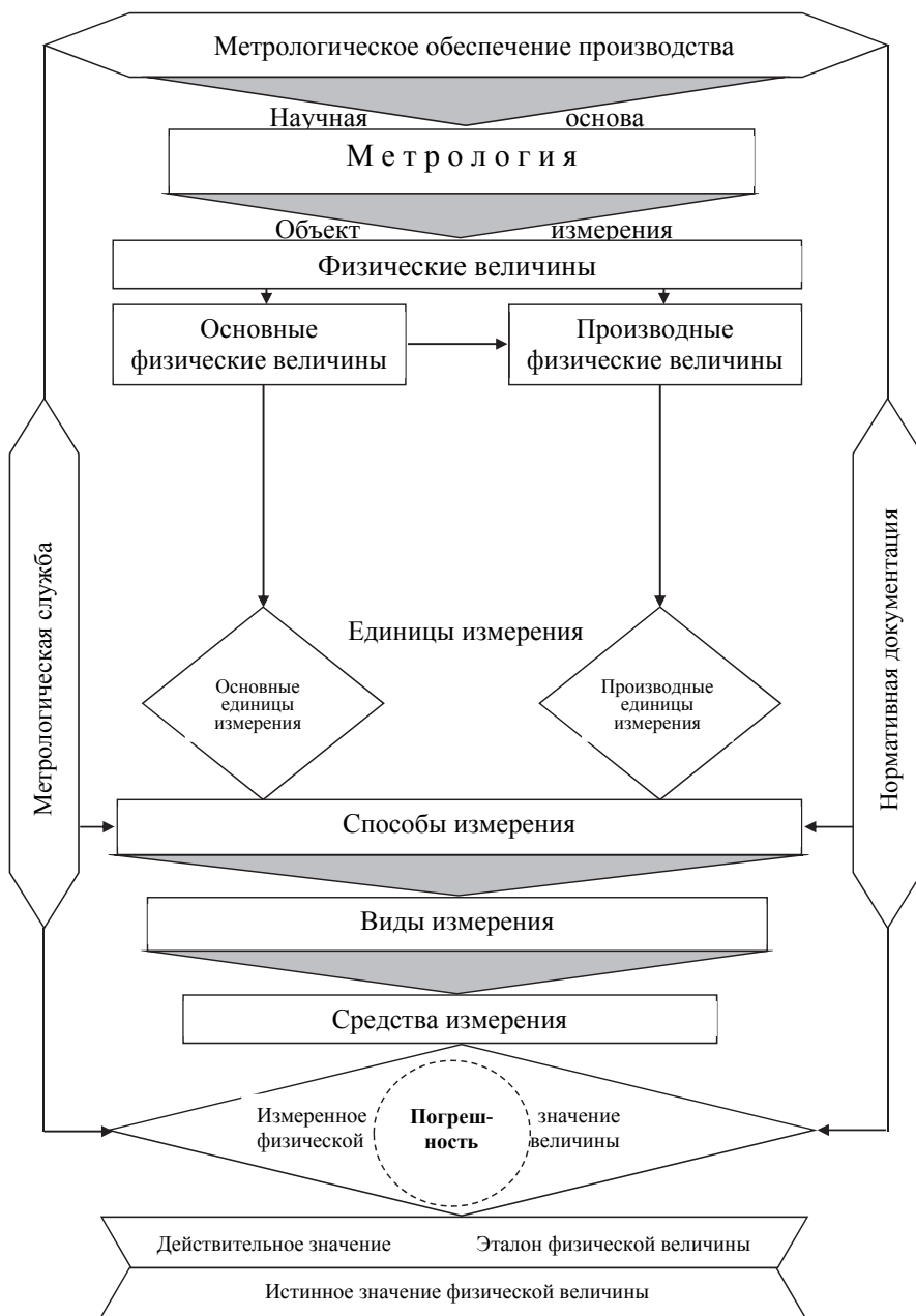
Рис. 1. Блок-схема «Метрологическое обеспечение производства»
