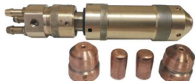
Опытно-промышленная модель плазмотрона ПМВР-5.1
